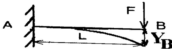
FigII.13 Poutre encastree soumise a une charge concentree
