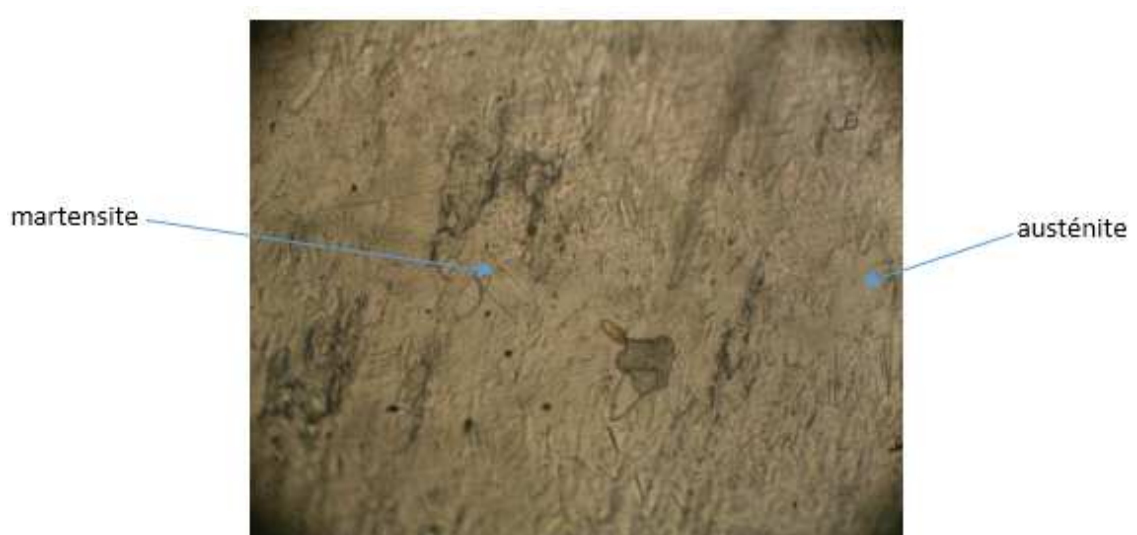
Figure III.12 : Micrographie optique de l'échantillon à 75°C
