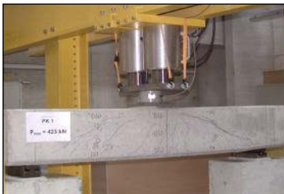
Figure I-30 : Essais d'effort tranchant sur des colonnes en béton avec ou sans renforcements par des tissus en CFRP [19]
