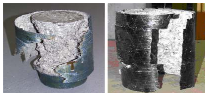
Figure I-28 : Rupture de colonnes renforcées par des confinements en fibres d'aramide et de carbone [19]
