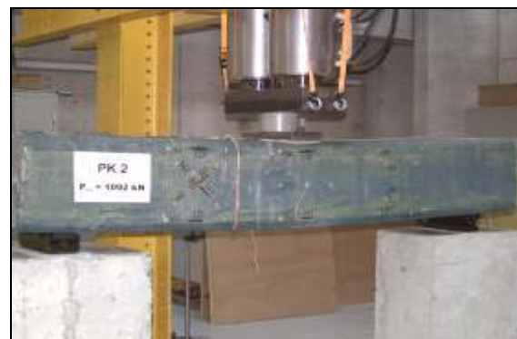
Figure I-30 : Essais d'effort tranchant sur des colonnes en béton avec ou sans renforcements par des tissus en CFRP [19]
