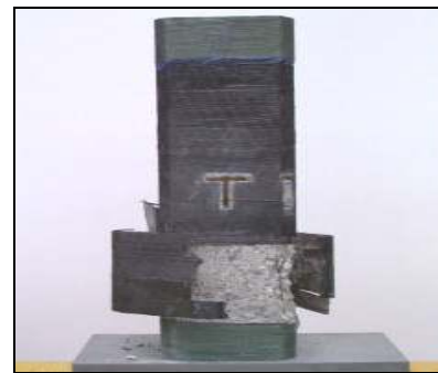
Figure I-27 : Rupture d'une colonne carrée avec confinement en carbone [19]
