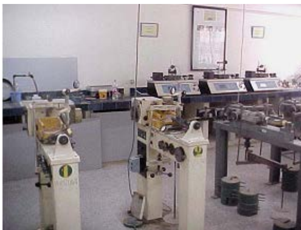
Figure 81 : Dispositif de l'essai de cisaillement.
