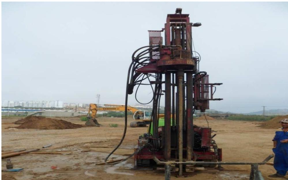
Figure 2.2.1 : sondeuse à chenille de marque TECOINSA TP-50 et APAFOR 500
