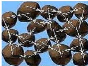
*b- La longueur des flèches représente l'amplitude des forces de contact entre différents grains de sol.*
