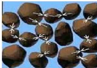
*c- Réduction des forces de contact et augmentation de la pression interstitielle.*
