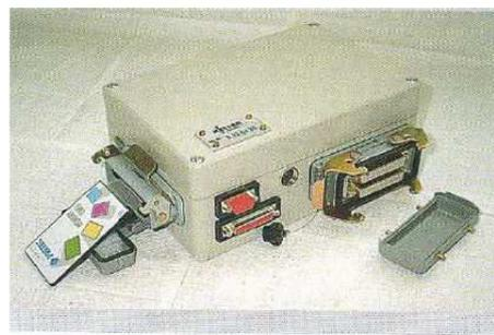
Figure 1.3.17 : Clavier et unité centrale de l'appareil de mesure M4 (Document de Keller)
