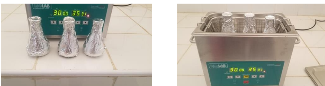
Figure 24: Extraction des composés phénoliques par bain d'ultrason (Originale, 2020)
