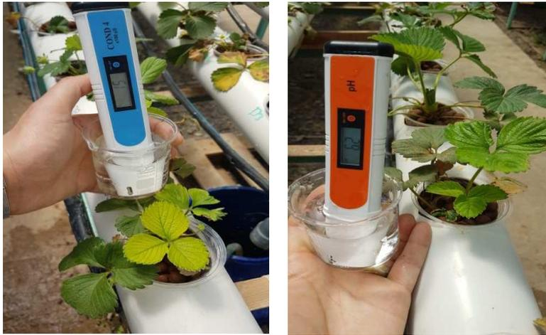
**Figure 15** : pH mètre et EC mètre
