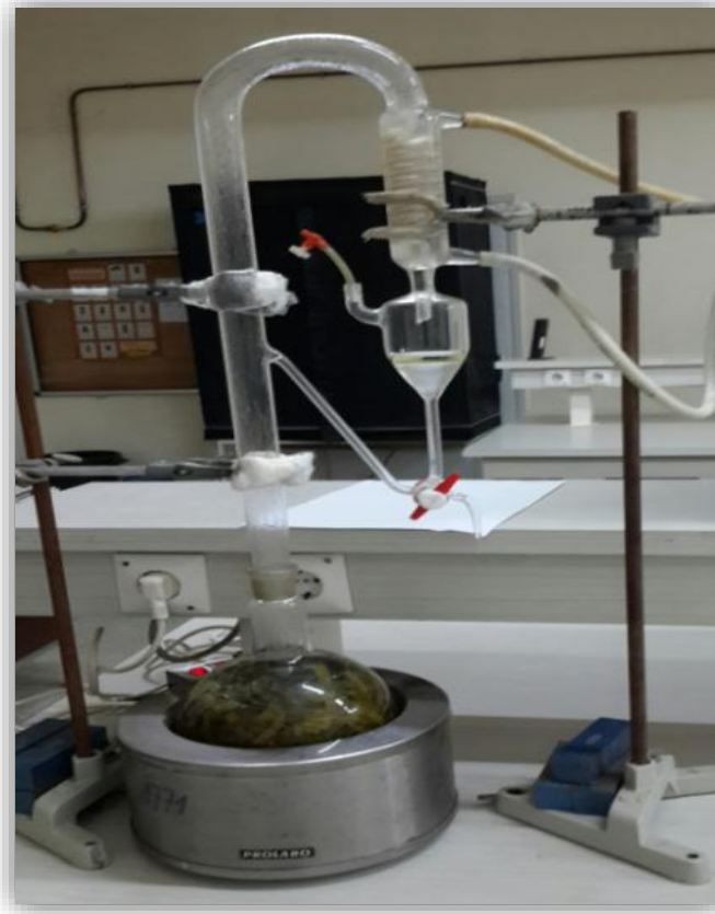
Figure 12 : Montage de l'appareil Clevenger du procédé de l'hydrodistillation (Originale)
