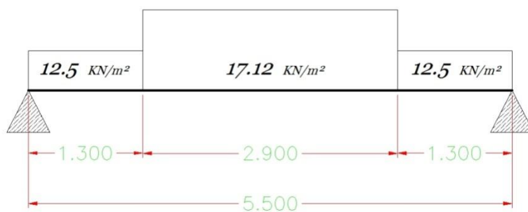
Figure III.8 : schéma simplifié du chargement de la poutre à l'ELU
