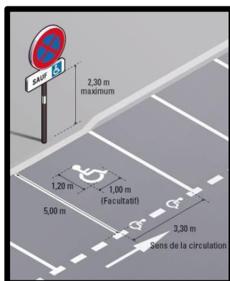
Fig.III.83 : places de stationnement pour PMR
