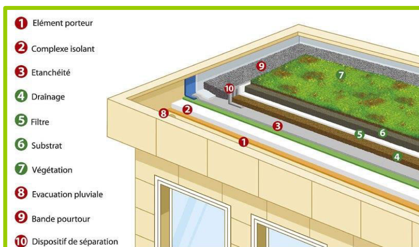
Fig.III.86 : les composants d'un toit vert Source : www.vegetalid.fr
