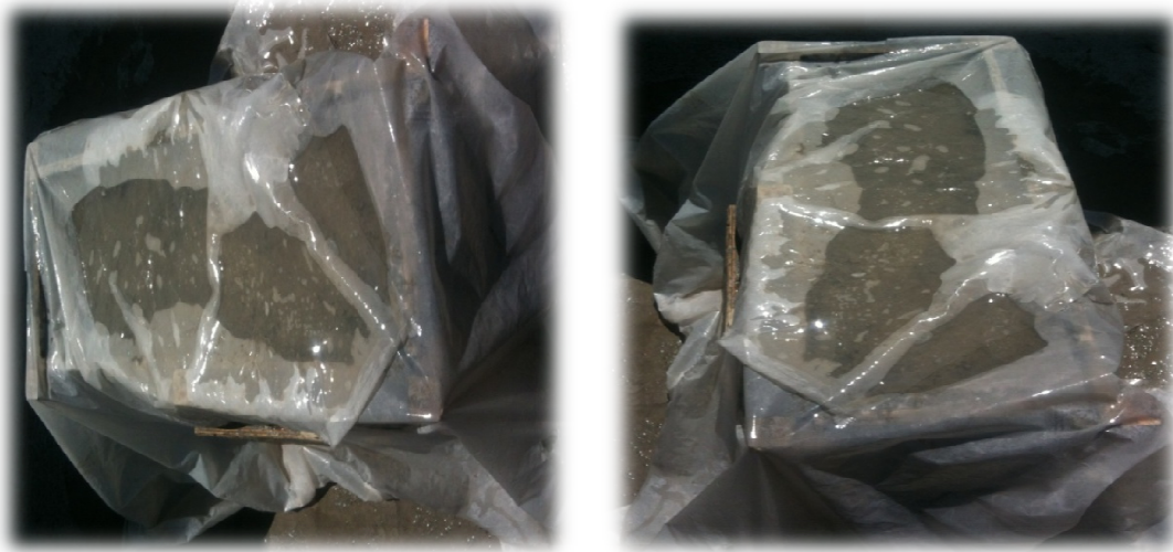
Figure 3.18 : Cure des blocs
