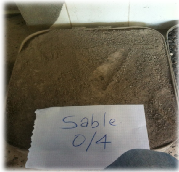
Figure 2.8 : échantillon du sable 0/4 .
