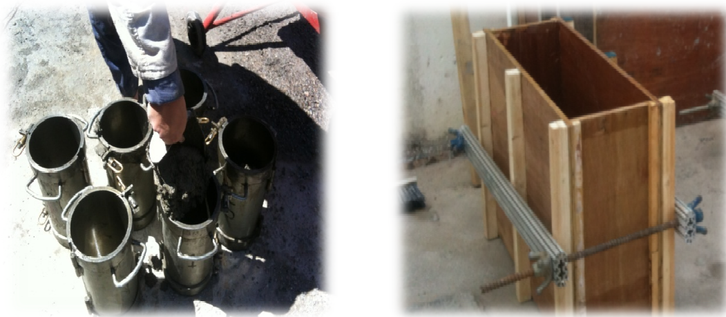
Figure 3.16 : Préparation des blocs et cylindres
