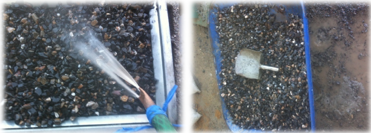
Figure 2.11 : Essai de propreté
