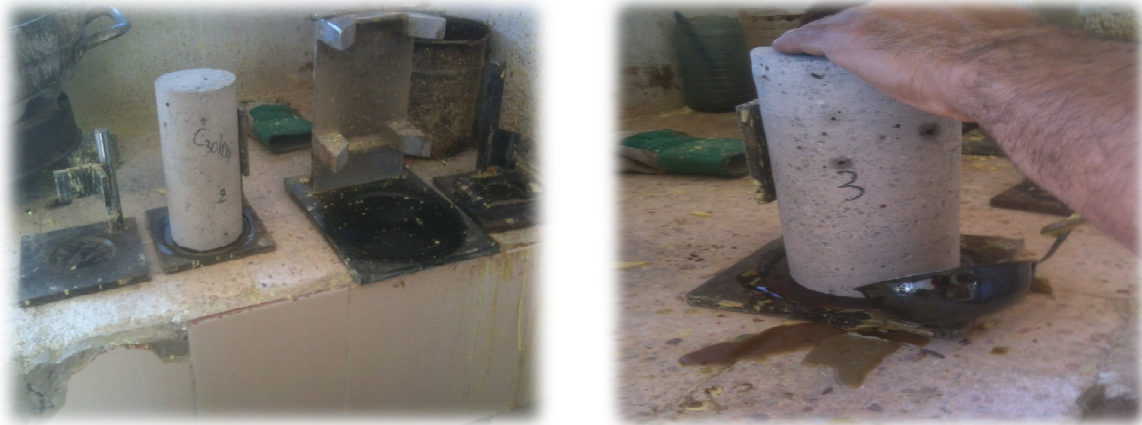
Figure 3.25 : Moment de surfaçage
