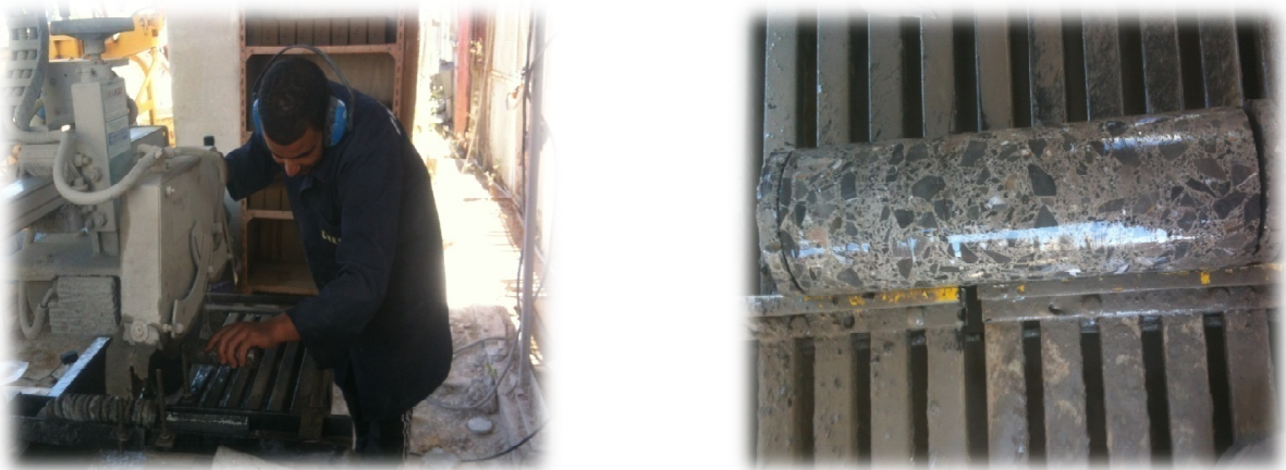
Figure 3.23 : Découpage des carottes
