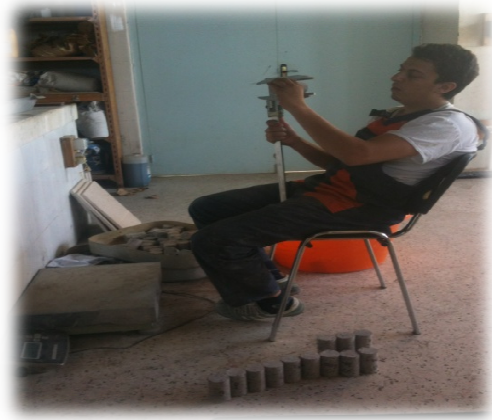
Figure 3.24 : Mesure des carottes
