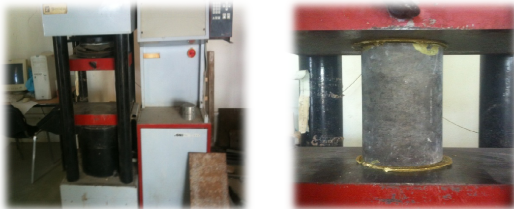
Figure 3.27 : Ecrasement cylindre normalisé
