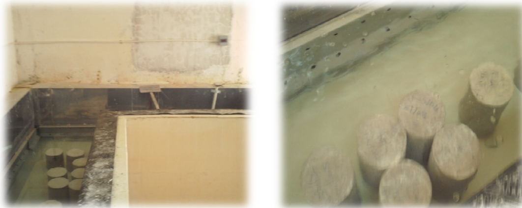
Figure 3.19 : Cure des éprouvettes normalisées
