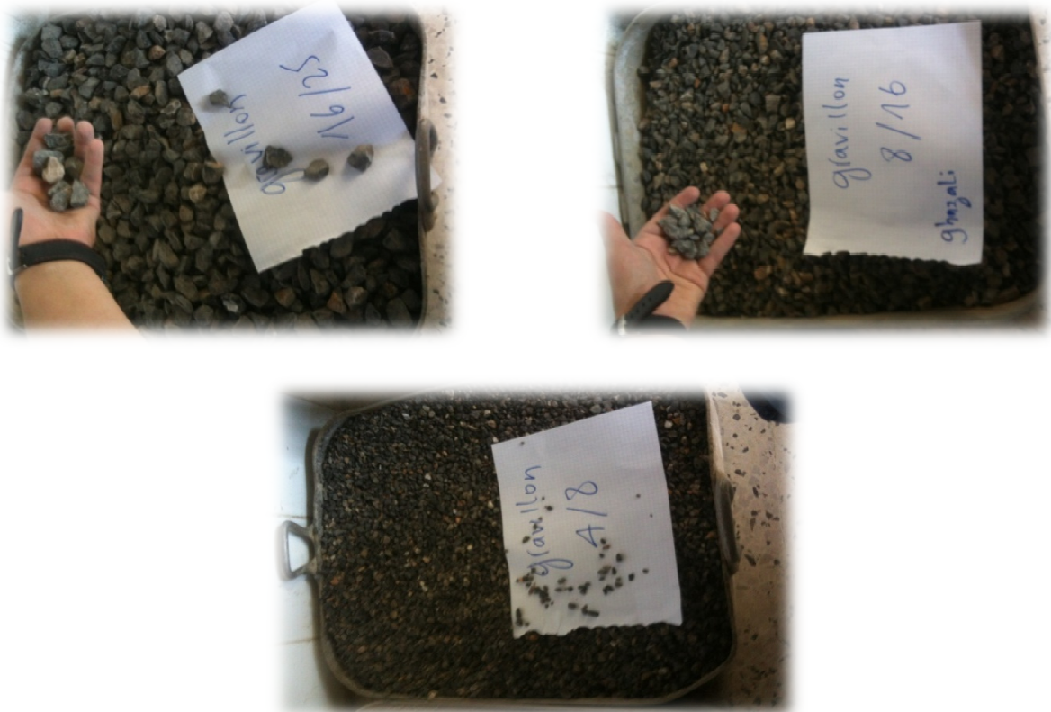
Figure 2.10 : Echantillons des gravillons : 4/8, 8/16, 16/25
