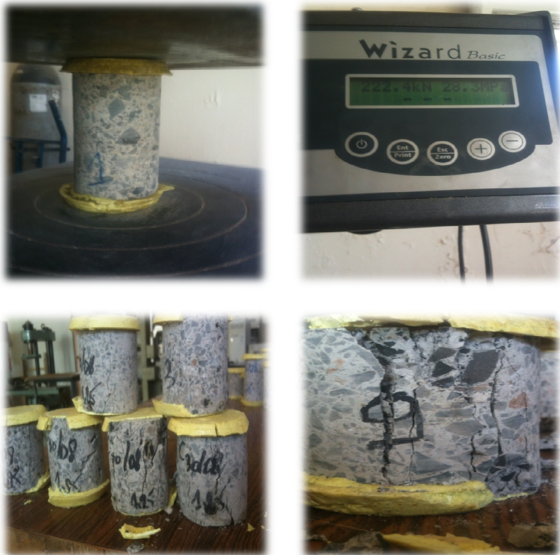
Figure 3.28: Exemple d'essais d'écrasement sur éprouvette et carotte
