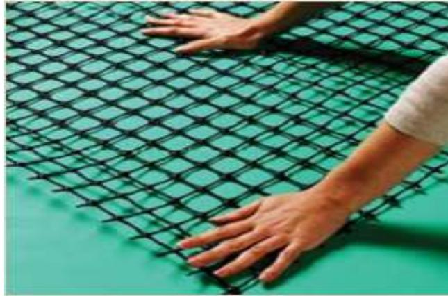
Figure 3.15: Exemple de géogrillebiaxiale
