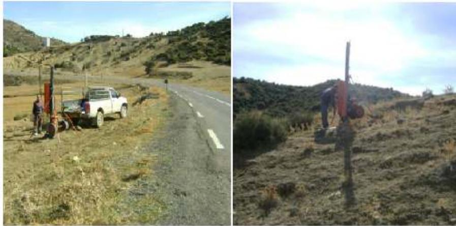
Figure 5.3: Schéma d'un pénétromètre dynamique dans plusieurs points.
