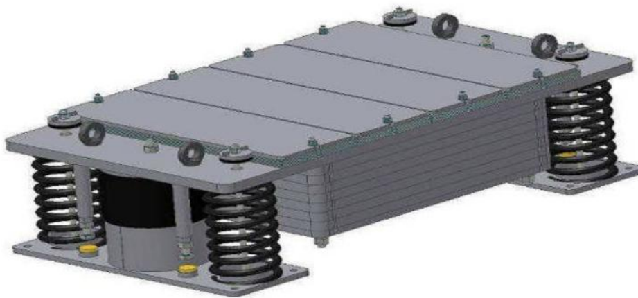
Figure 1.7 : Amortissement à masse accordée
