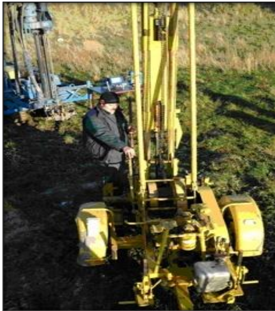
Figure III.15 : Essai au pénétromètre dynamique lourd.
