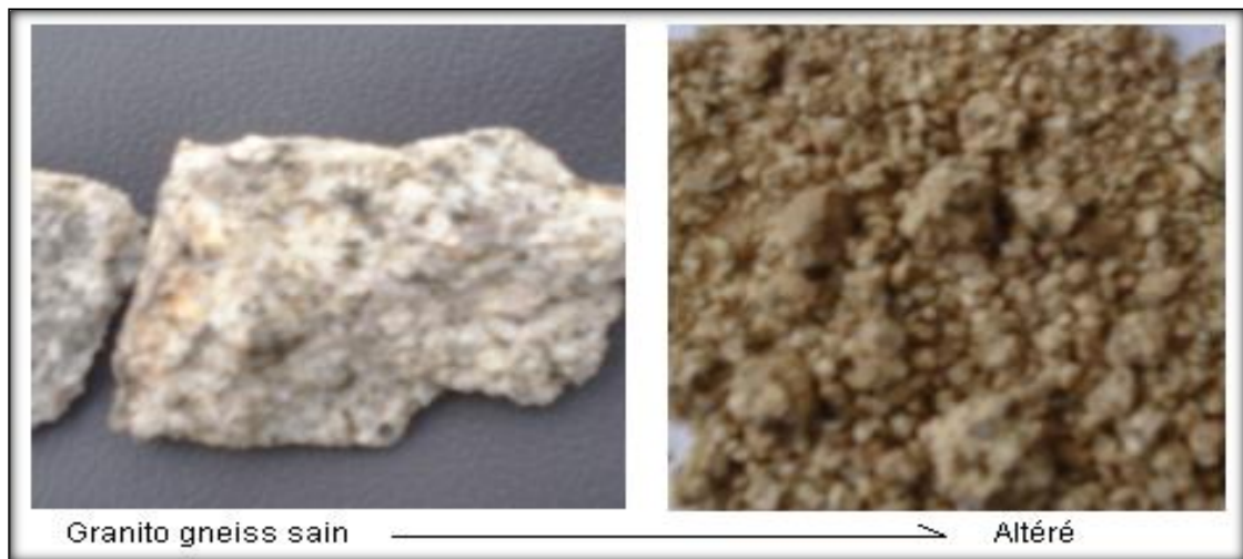
Figure IV.6 : Altération de la roche mère en élément argilo sableux.
