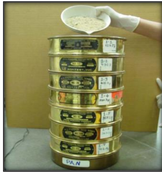
Figure III.21 : Appareillage d'analyse granulométrique par tamisage.
