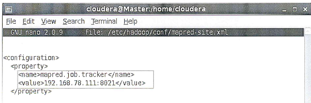
Figure 21 : Configuration de fichier /etc/Hadoop/conf/mapred-site.xml du Master
