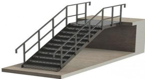
Figure 4. 6: Escalier en charpente métallique
