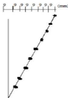
Figure VII.16. Inclinaison des poteaux de tous les étages de 9mm sur y-y.
