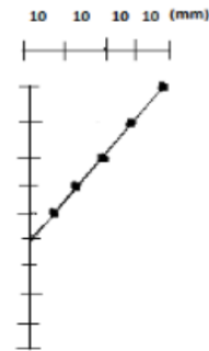
Figure VII.22. Inclinaison des poteaux de tous les niveaux de 10mm sur y-y.
