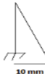
Figure VII.17. Inclinaison des poteaux du RDC de 10mm sur x-x.
