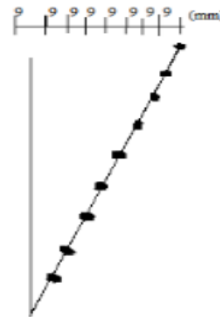
Figure VII.15. Inclinaison des poteaux de tous les étages de 9mm sur x-x.
