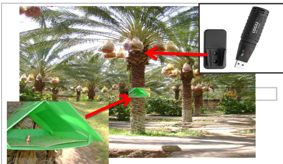
Figure 0-6 : Installation des outils de suivi de la biodynamique, A : piège AA TRAP, B : enregistreur de température et d'humidité log 32. (Originale)
