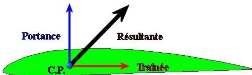
Figure I.14 : Résultante des forces aérodynamiques
