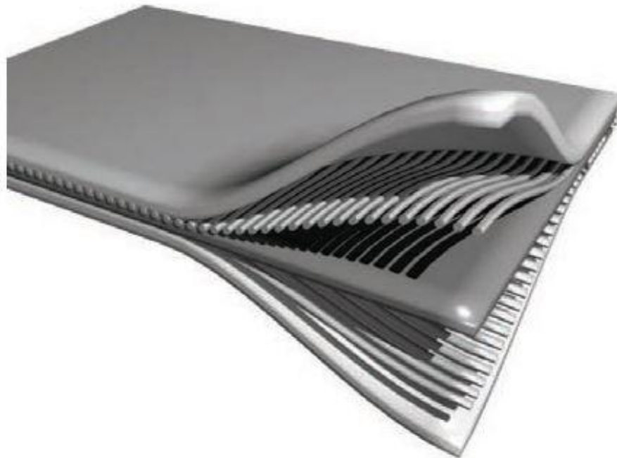
Figure I.12 : Esquisse d'un matériau composite renforcé de fibres
