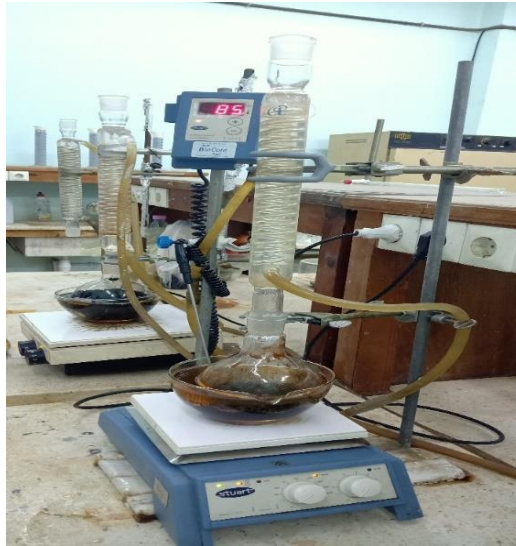
Figure 2.2: dispositif d'imprégnation de la poudre des Noyaux de Dattes
