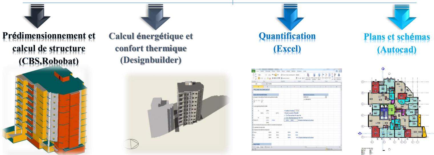
On modélise le bâtiment avec un logiciel de conception BIM (Revit, archicad, All plan,...) ensuite ça crée une interactivité entre les autres logiciels avec lesquels on veut exploiter les données selon les besoins étant donné que le modèle créé contient toutes les informations caractérisant le bâtiment.
