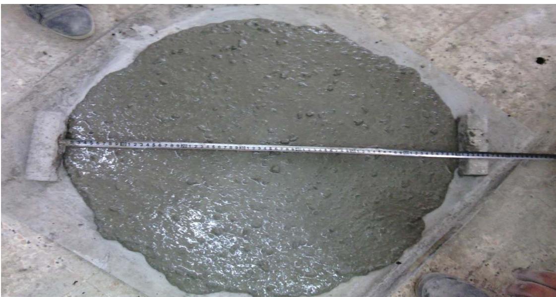
Figure 2.18 : Mesure du diamètre d'étalement.
