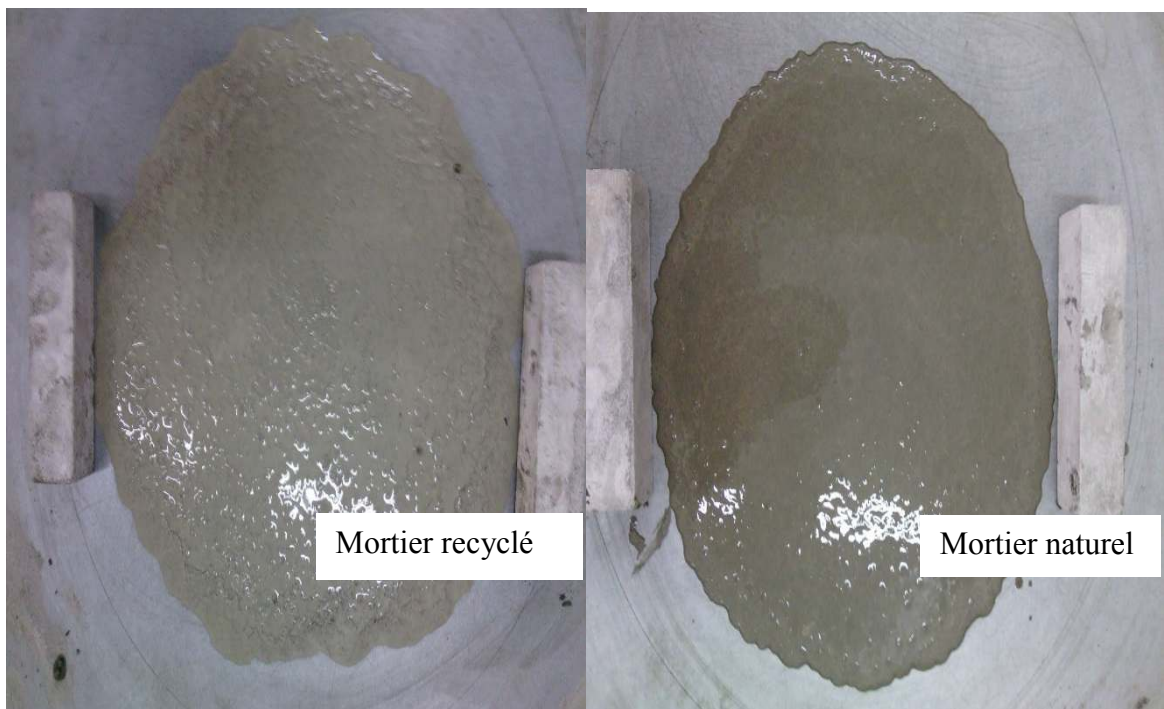
Figure 3.2 : L'étalement du mortier (Sp/P = 2.0%).
