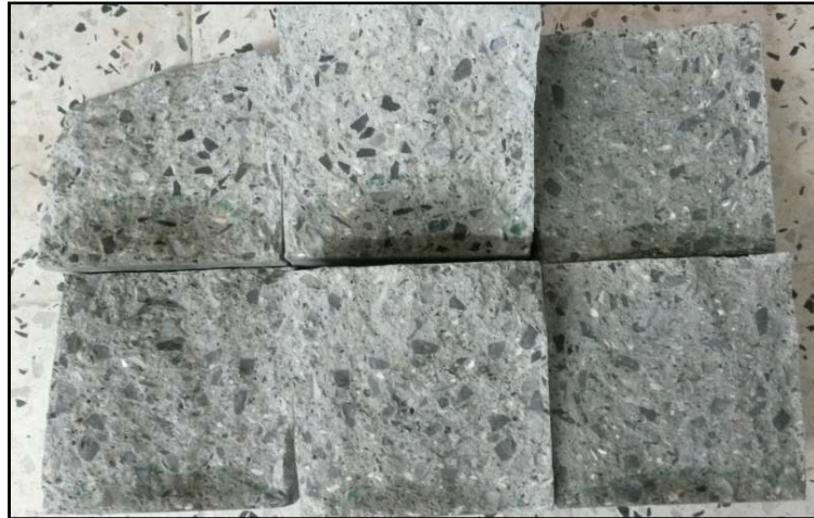
Figure 2.28: Mesure de la profondeur de pénétration d'eau.
