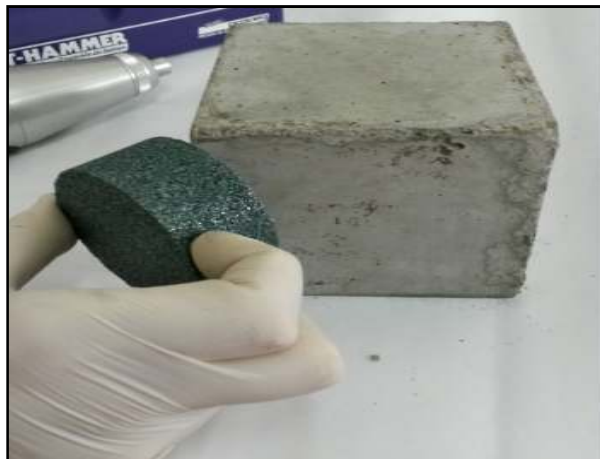
Figure 2.21: Ponçage des éprouvettes à l'aide de la pierre abrasive.
