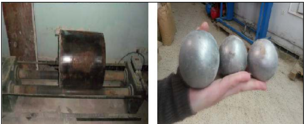
Figure 2.7 : Broyeur à boulets utilisé.
