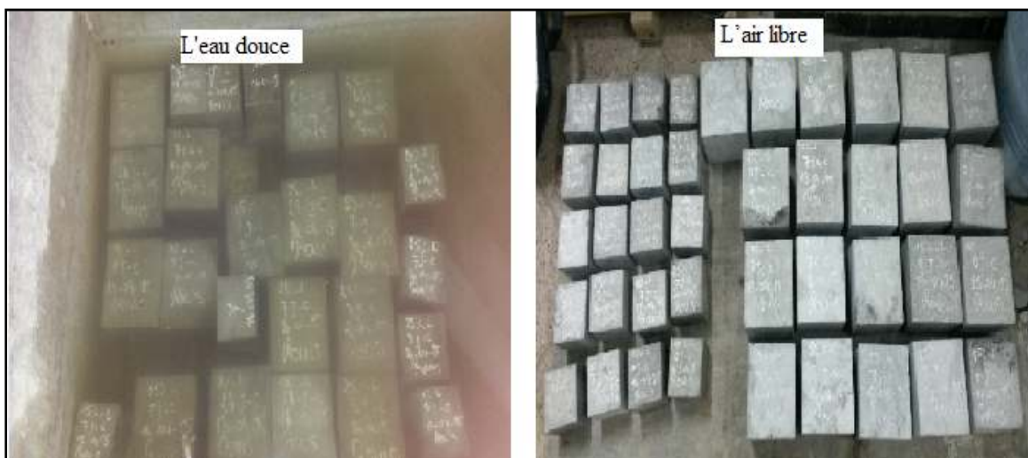
Figure 2.29 : Éprouvettes conservées dans l'eau douce et à l'air libre.
