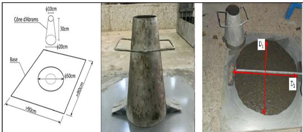
Figure 2.15: Essai d'étalement au cône d'Abrams et principe de la mesure de l'étalement.
