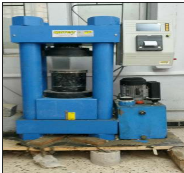
Figure 2.25: La presse de capacité de 3000 kN pour l'essai de compression simple.
