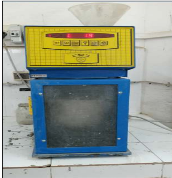
Figure 2.10: Le malaxeur à mortier de 5 litres de capacité.
