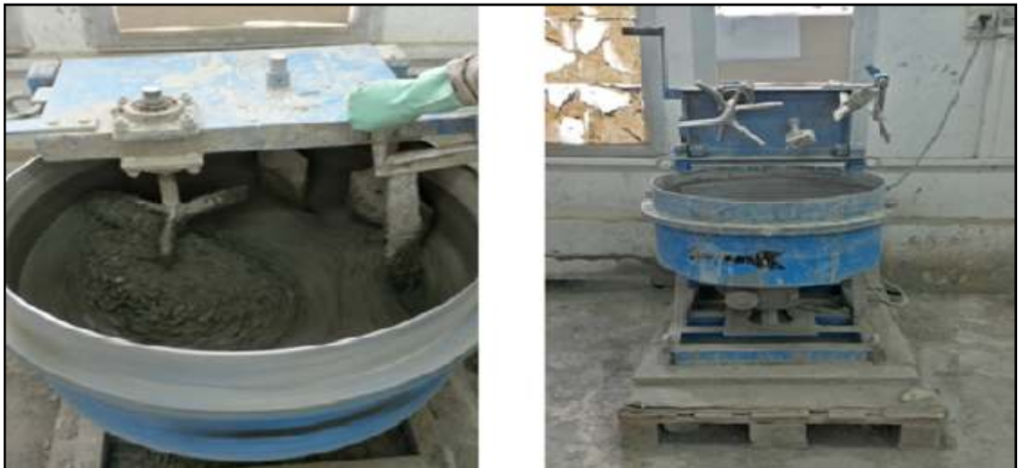
Figure 2.14 : Le malaxeur à béton de 40 litres de capacité.
