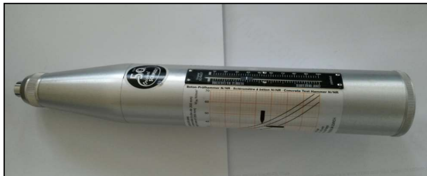
Figure 1.24: Marteau de rebondissement de Schmidt type N.
