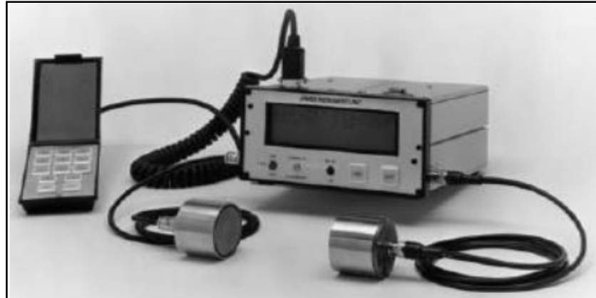
Figure 1.25: Appareil de mesure de la vitesse d'impulsion [101].
