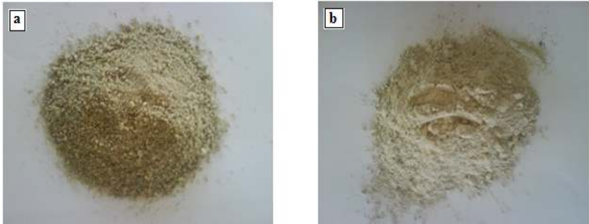
Figure 2.6 : : Laitier granulé de haut fourneau utilisé (a) avant broyage, (b) après broyage.
