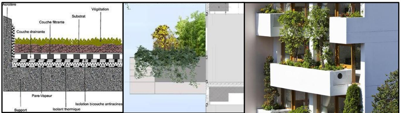
**fig :** les pots en saillie de la façade structure coupe, schéma et photo
