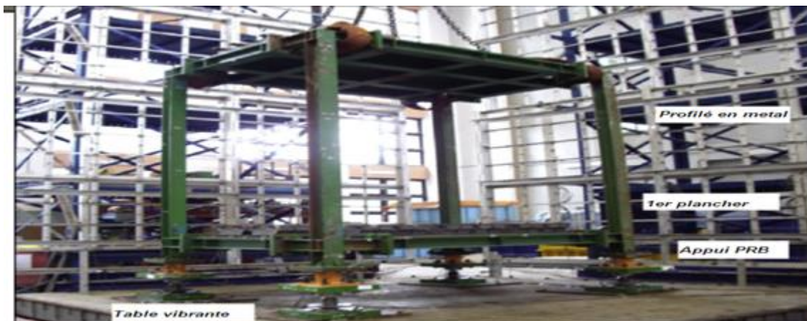
Figure 2.23 : Portique en charpente métallique posé sur table vibrante supporté par un appui PRB
