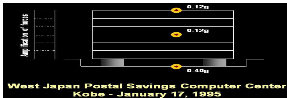
Figure 2.12 : Déplacement constant dû à un résidu de force d'inertie transmise par l'Isolateur d'une même structure qui oscillait lorsqu'elle était fixée
