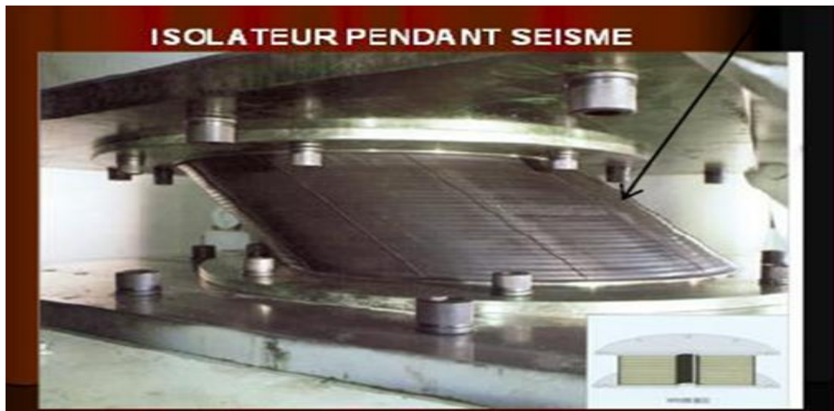
Figure 1.3: Isolateur System en plein mouvement latéral
