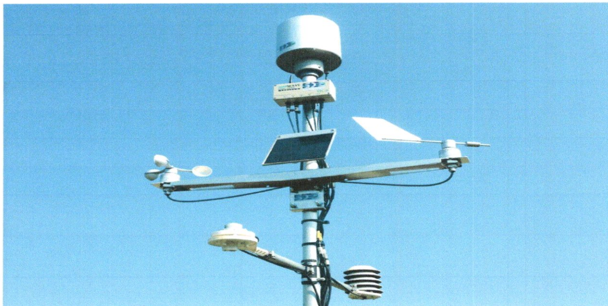
Figure 1.17 : station météo a transmission radio
