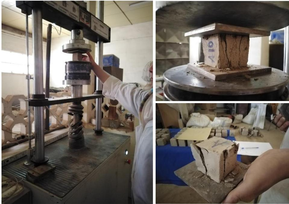
Figure 6.30 : Essai d'écrasement des éprouvettes d'adobe.
