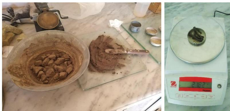
**Figure 6.12 :** Essai des limites d'Atterberg.
