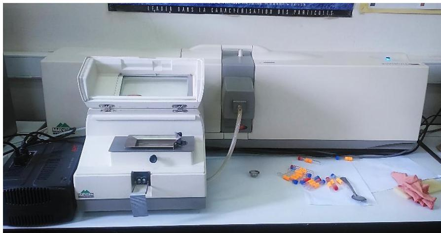
**Figure 6.7 :** Granulomètre laser Mastersizer 2000.
