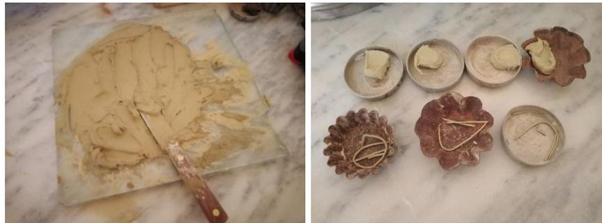
Figure 6.20 : Essai des limites d'Atterberg d'argile.
