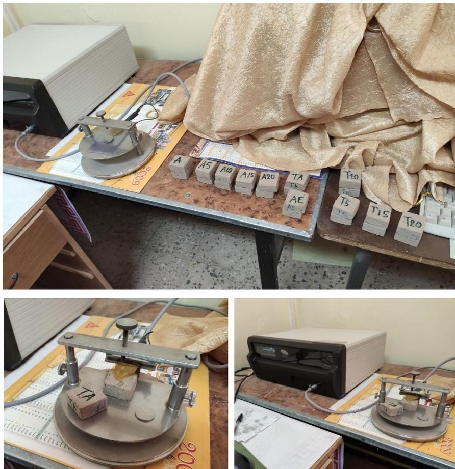
Figure 6.29 : Appareillage de la méthode de la Sande Plane Transitoire (TPS).
