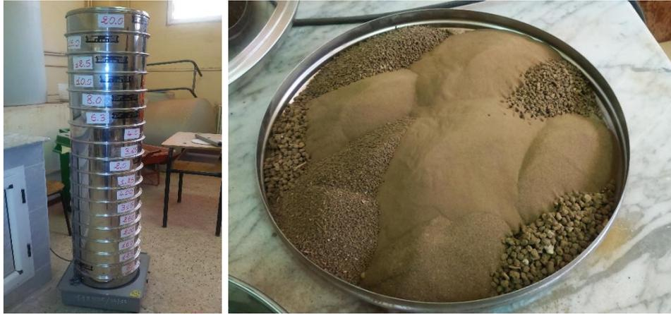
**Figure 6.6 :** Essai d'analyse granulométrique par tamisage.
