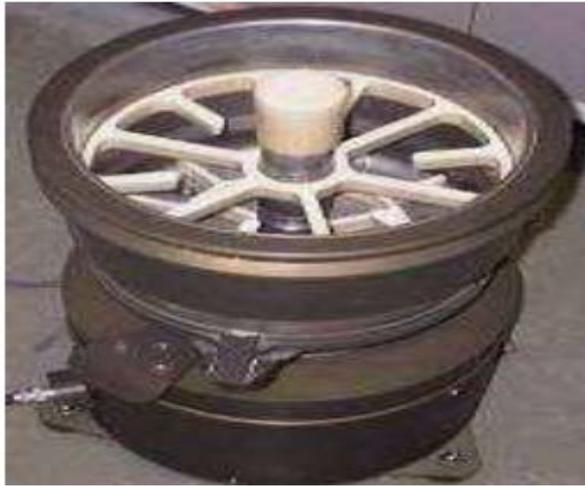
Figure 1.16: Rhéomètre à béton BT Rhéom.
