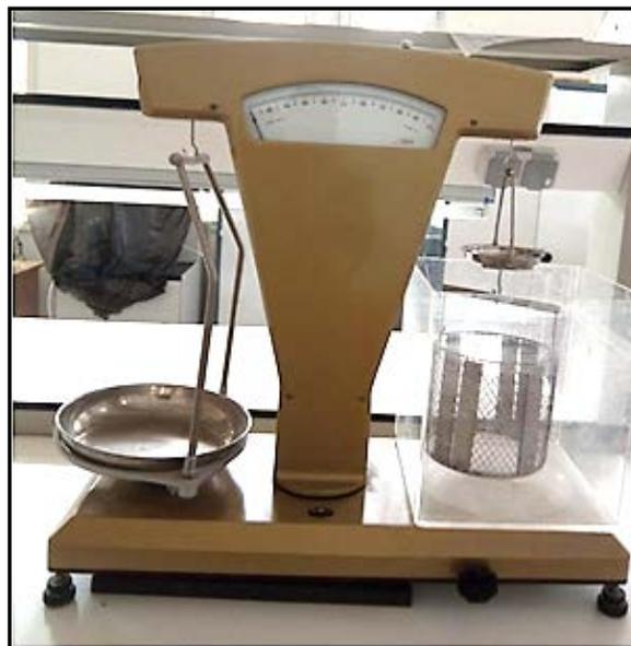
Figure 4.24: Balance hydrostatique.
