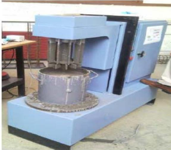
Figure 1.15: Rhéomètre BML.
