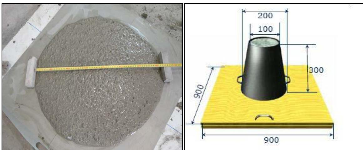
Figure 4.10 : Essai d'étalement (Flow test).
