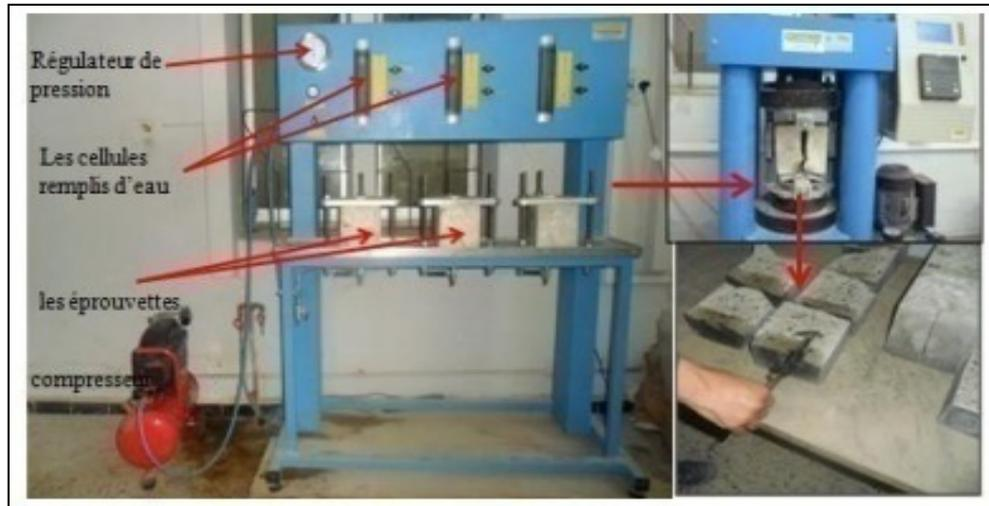
Figure 4.25 : Essai de perméabilité à l'eau.
