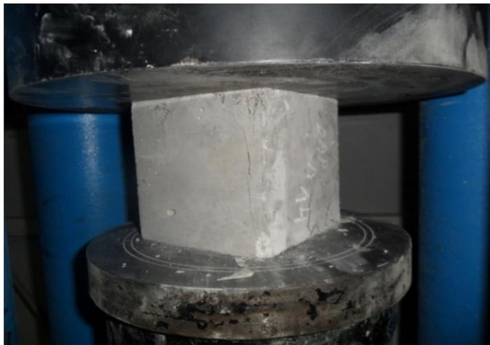
Figure 4.19: Dispositif de l'essai de compression simple.
