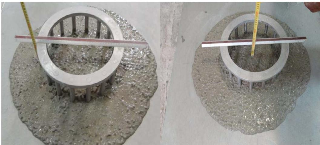
Figure 4.13 : Mesure des hauteurs à l'intérieur et à l'extérieur du J-Ring.
