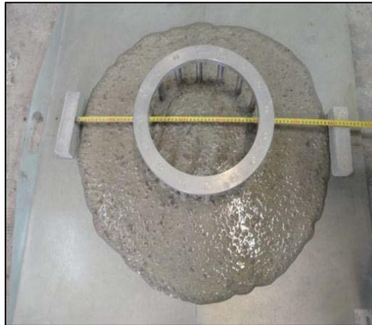
Figure 4.12 : Mesure d'étalement en présence du J-Ring.
