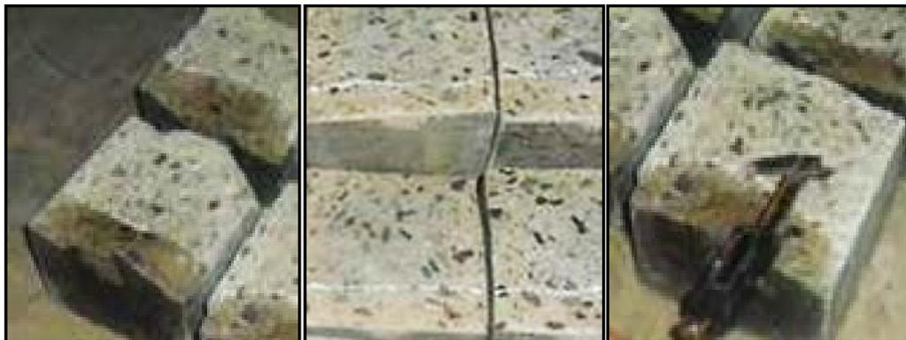
Figure 4.26: Mesure de la profondeur de pénétration d'eau.
