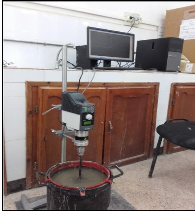
Figure 4.17: Essai au Rhéomètre.
