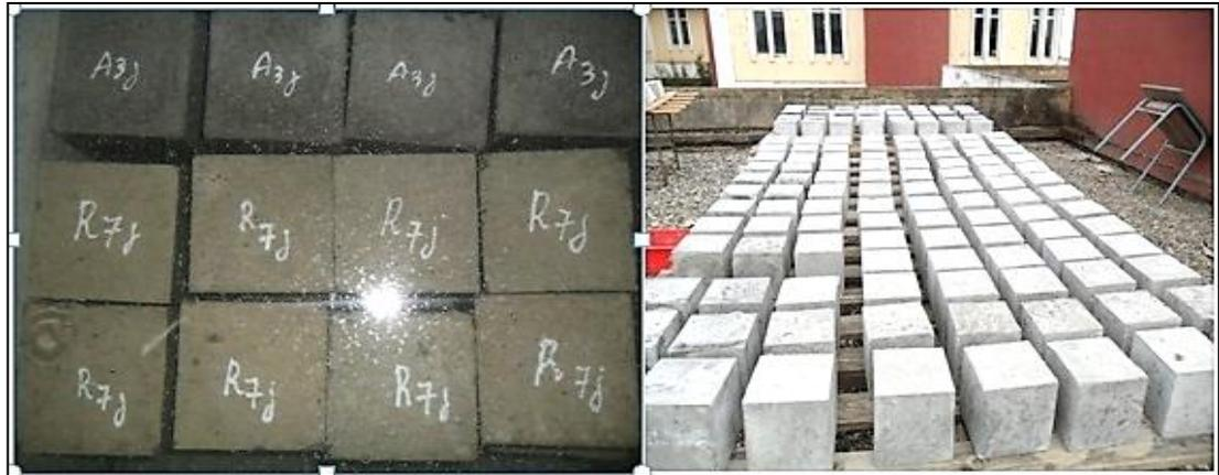
Figure 4.27: Les éprouvettes conservées dans l'eau douce et à l'aire libre.
