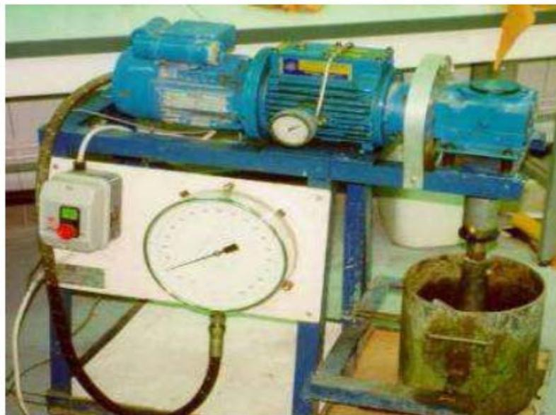
Figure 1.13: Rhéomètre two-point-test [29].
