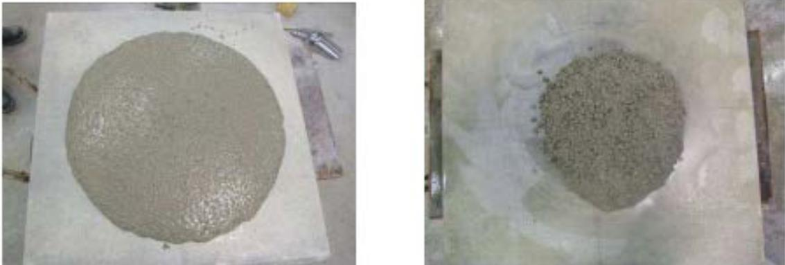
Figure 1.2: Essai d'étalement sur un BAP composé de sable roulé (a) et de sable concassé (b).
