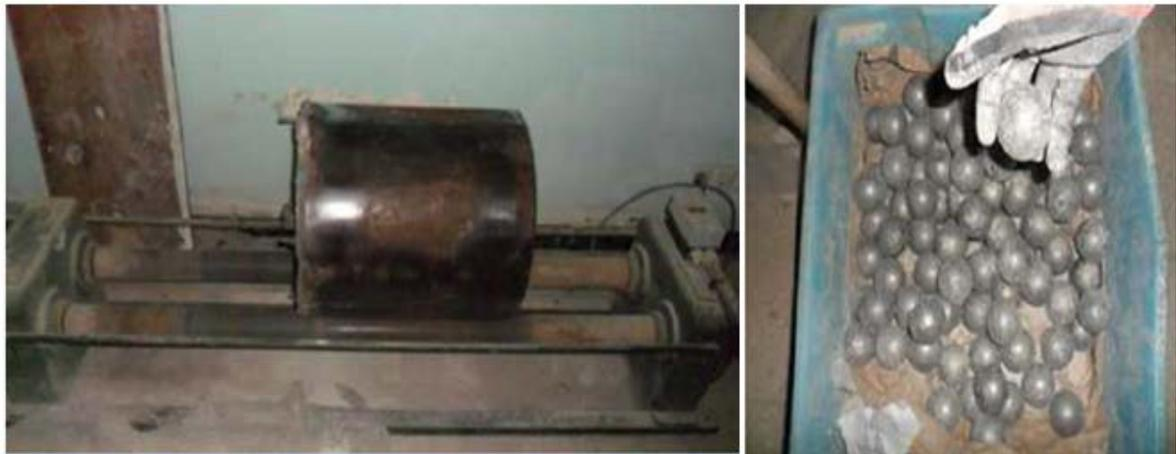
Figure 4.2: Broyeur à boulet utilisé.
