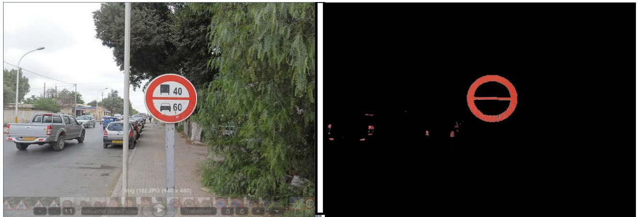
Figure.3.6 Image original d'un panneau d'interdiction et son extraction de couleur (rouge).
