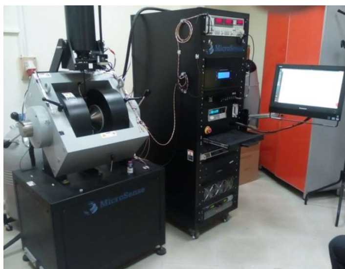
Figure 3.8 : Magnétomètre à échantillon vibrant (VSM) du CRTI.
