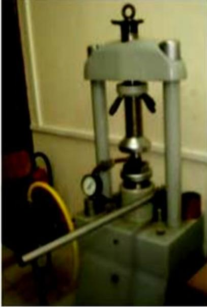
Figure 2.9 : Presse hydraulique
