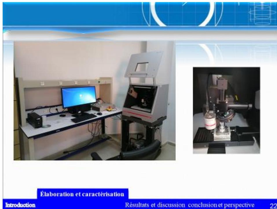
Figure 2. 17 : Duromètre INNOVA TEST 9000 (CRTI).
