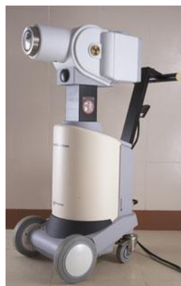
Figure I.9 : Projecteur de source d' 192 Ir MicroSelectron®, Elekta
