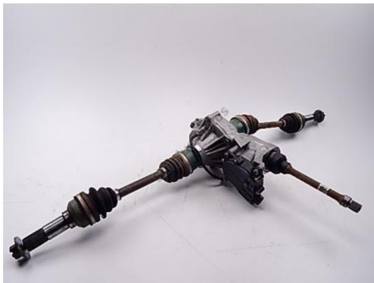
Figure 1.2: Pont moteur avant (direction).
