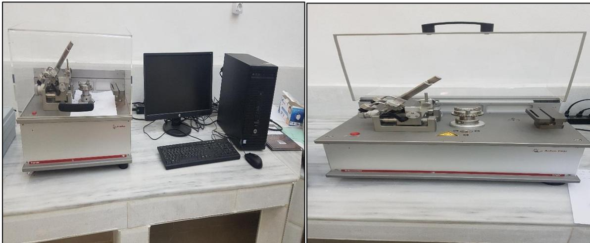
Figure III.30 : Tribomètre de marque Anton Paar utilisée.
