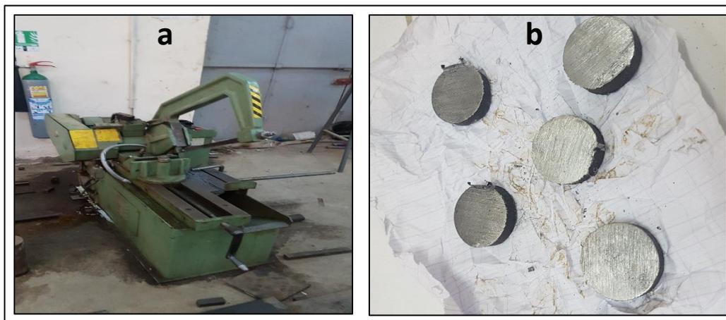
**FigureIII.1** :a) Scie mécanique, b) échantillons en acier (A60).
