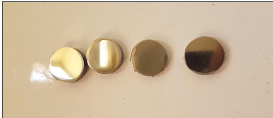
**Figure III.3 :** échantillons en acier après polissage.
