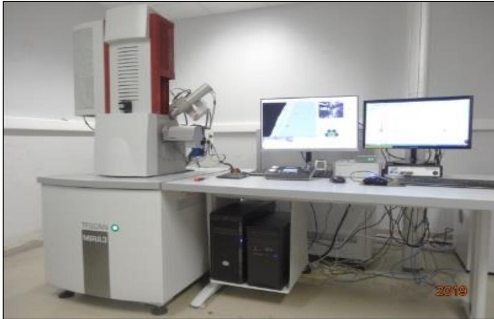
**FigureIII.25** : Microscope électronique à balayage (MEB)
