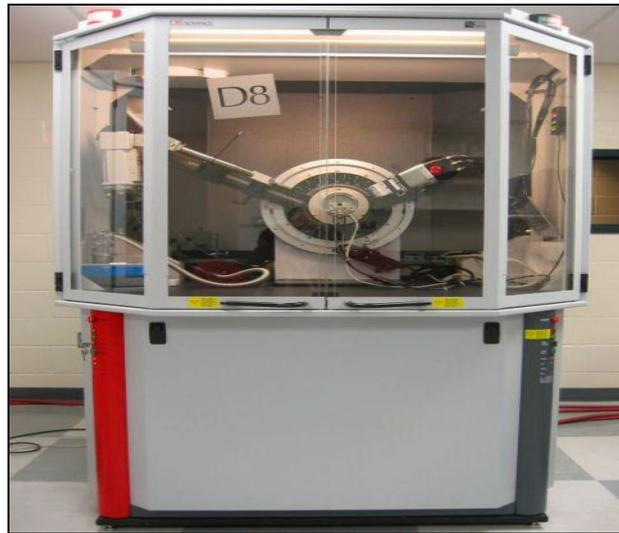
**Figure III.24 :** Diffractomètre de type Bruker ADVANCE 8
