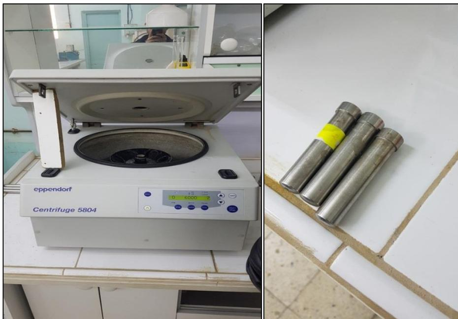
**Figure III.7 :** Centrifugation du mélange eau/ acétone et graphite à une vitesse de 1000tr/min pendant 20 min.
