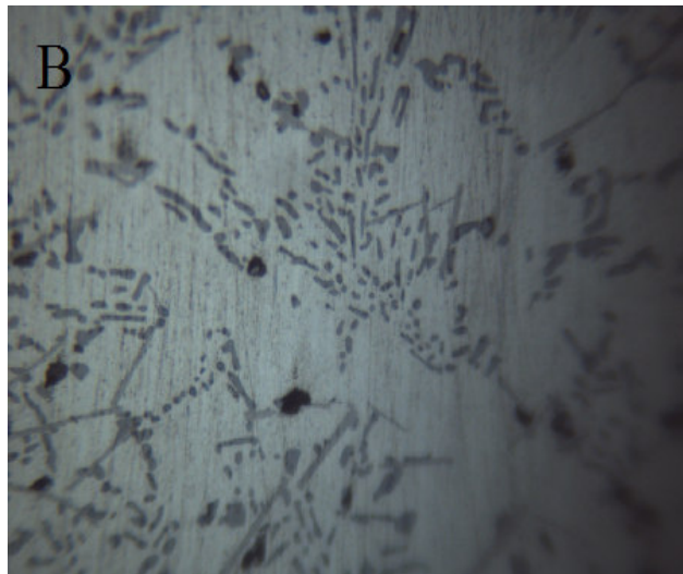
Figure IV. 33: microscope optique l'effet de Mg sur la microstructure de l'alliage traité thermiquement. (B) M2 alliage avec 0,62% Mg.
