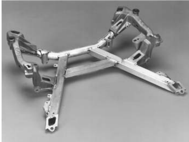
Figure I. 1 : Des extrusions soudées 6063 combinées avec un tube 5083 et une coulée 357 composent la carrosserie de l'essieu de la BMW Model 5.
