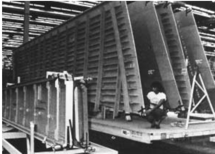
Figure I.3 : Les structures critiques des ailes des avions sont souvent en tôle d'alliage 7xxx ou construction d'extrusion à rigidité intégrale ; alliage 7075-T73 ou alliages de haute ténacité tels que 7050 ou 7475 sont parmi les principaux choix.
