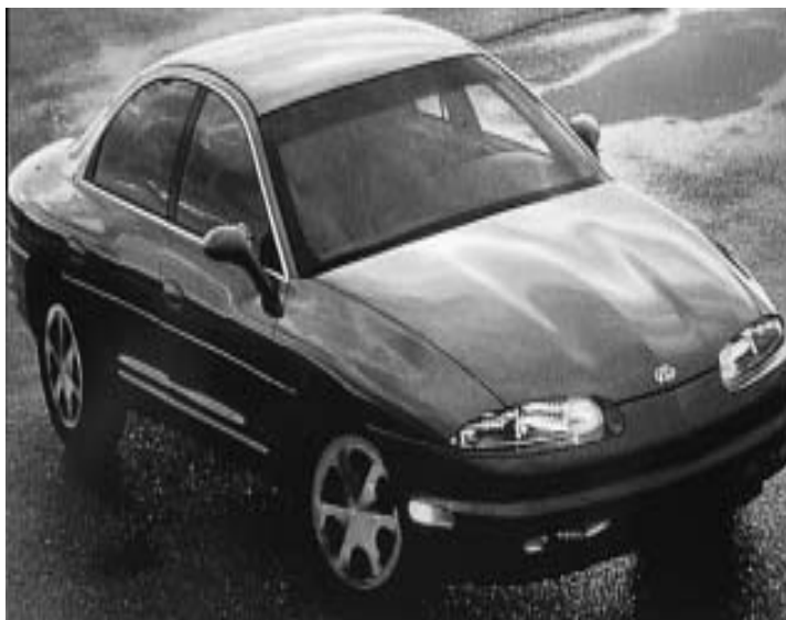
Figure I. 2 : Le General Motors Aurora, comme beaucoup d'autres automobiles de production, a des panneaux de fermeture en aluminium d'alliage 6111-T4.
