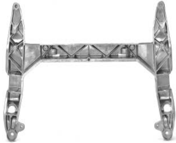
Figure I. 7 : Les composants des avions sont fabriqués à partir d'alliages d'aluminium moulés à haute résistance, tels que l'alliage 201.0 .
