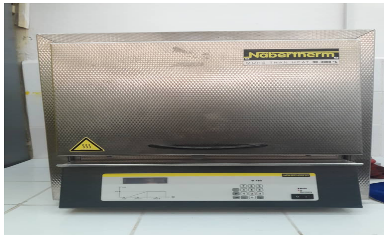
Figure III. 19 : Le four utilisé pour le traitement de mise en solution.
