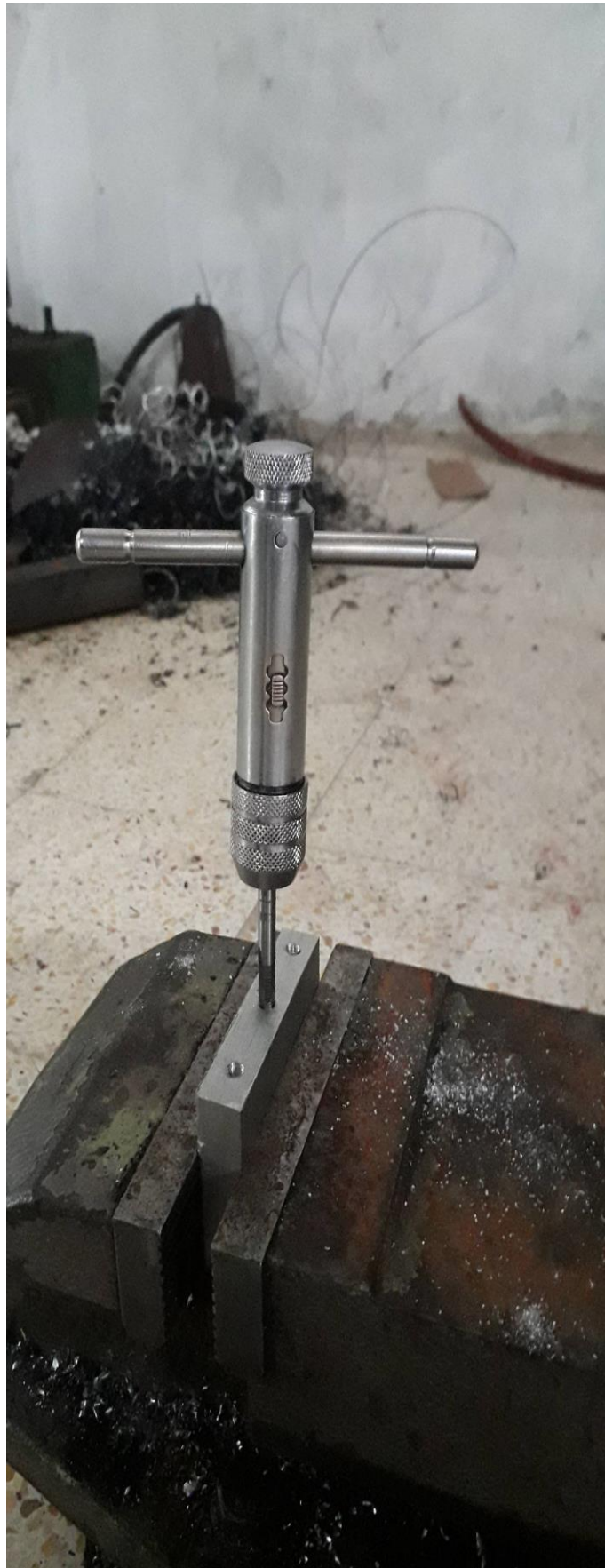
Photo A. 10: Taraudage des trous
