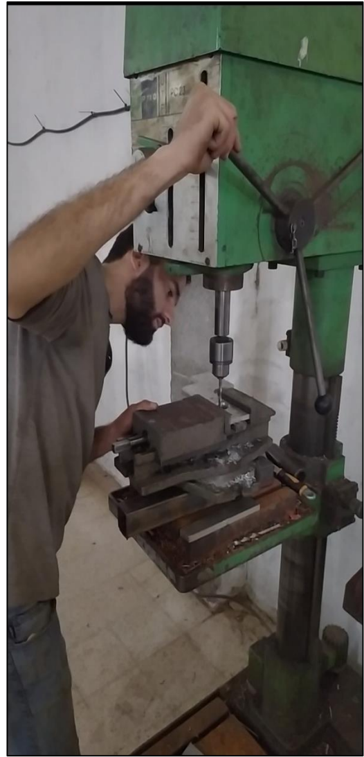
Photo A. 9 : Découpage et perçage des composants de la machine
