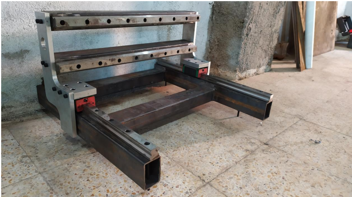
Photo A. 6: Assemblage et vérification de l'alignement du portique
