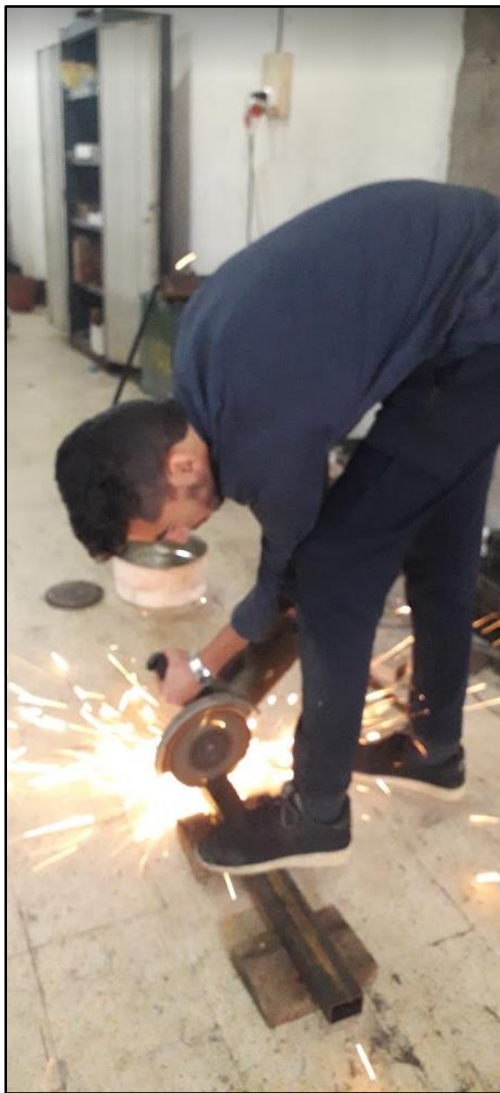
Photo A. 9 : Découpage et perçage des composants de la machine
