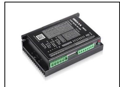
Figure 2. 19 : Carte de commande SH-DM542
