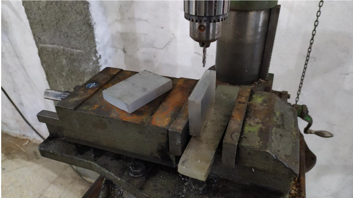
Photo A. 5: Perçage des plaques support du chariot
