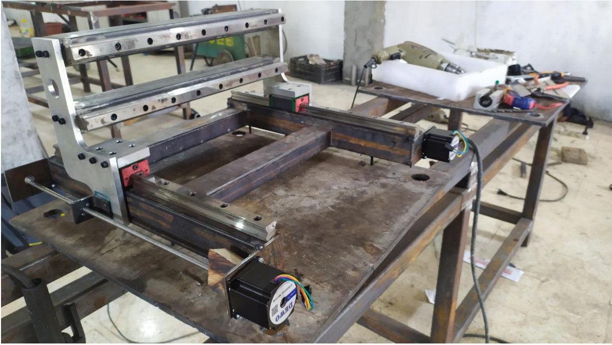
Photo A. 7: Vérification d'alignement de l'axe du moteur et vis trapézoïdale
