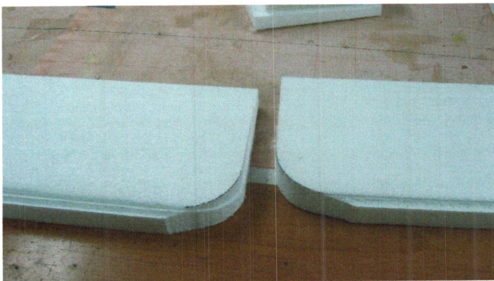
Figure 6-9. L'erreur de découpage des ailes
