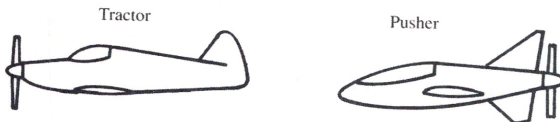
Figure 3-1. Configurations de moteur à hélice : Tracteurs et pousseur
