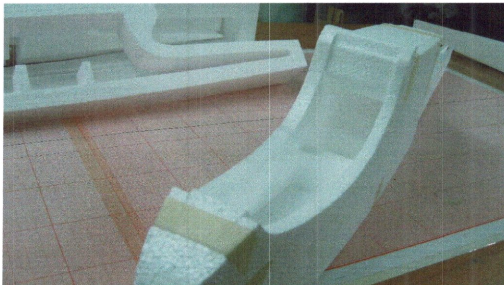
Figure 6-4. Collage du fuselage a l'intérieur
