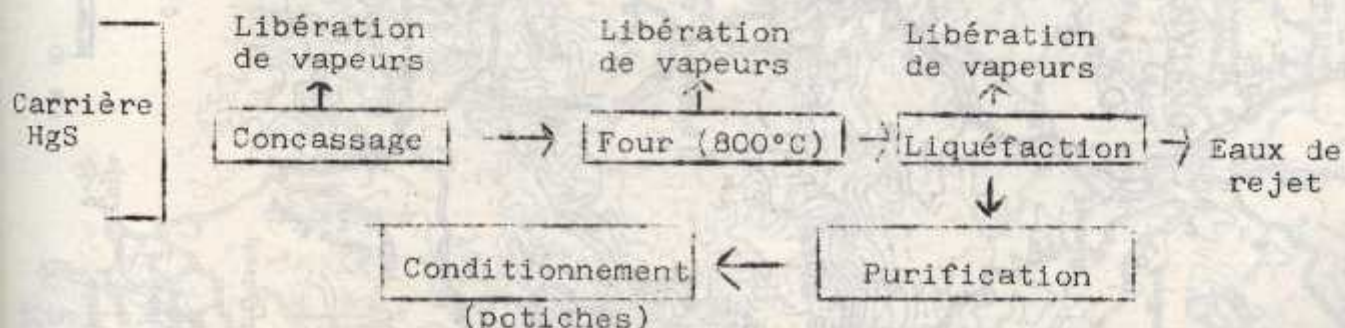
Fig. 8 : Schéma de production du mercure
