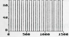
Fig3.16.1: La commande VSS, modèle de Slate. K_p: 0.72 , T_i: 30s , T_c: 45s , \tau: 40s \alpha: 0.4 , valeurs nominales des paramètres du système
