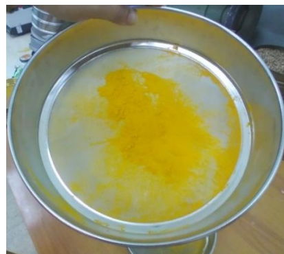
Figure V.5 : Particules de la curcumine retenue au tamis.
