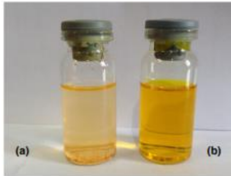
Figure I.8 : Solubilité de la curcumine (a) et de la nanocurcumine (b) dans l'eau.[58]
