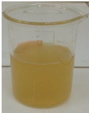
Figure V.7 : Nanosuspension de curcumine avec lécithine de soja et gomme arabique comme stabilisants
