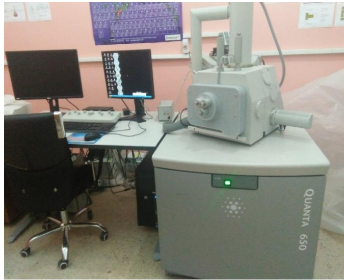
Figure 1 : Microscope électronique à balayage
