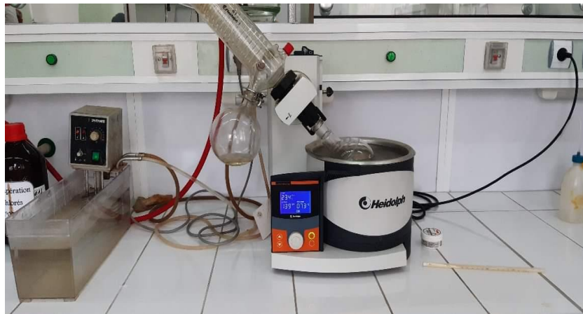
Figure 11 : Chauffage à 80°C et agitation de mélange DMSO avec farine de plumes.
