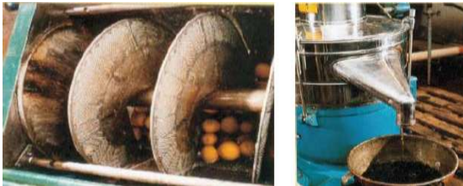
Figure 1.2: Photos à gauche d'une Pelatrice et à droite d'une centrifugeuse séparatrice de l'essence de citrus des eaux résiduelles.
