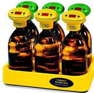
Figure : DBO mètre de type OXITOP IS6.
