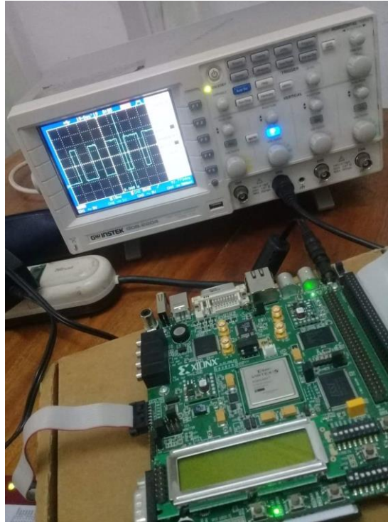
Figure 5.6 : Signal de commande d'un interrupteur généré à travers la carte FPGA.
