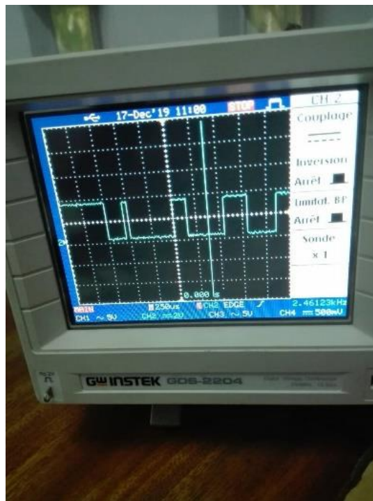
Figure 5.17 : Signaux de commande générés par la carte FPGA
