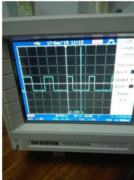
Figure 5.13 : Signaux de commande générés par la carte FPGA
