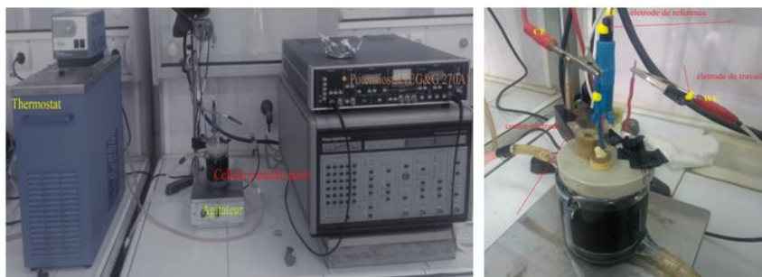
Figure IV. 1 Montage pour l'électrodéposition d'oxyde cuivreux, bain thermostaté, Potentiostat (EG&G 270A) et cellule électrochimique
