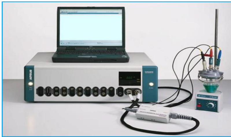
Figure II.19 Spectroscopie d'impédance électrochimique (EIS) Montage expérimental, Potentiostat/galvanostat type AutoLab 302N.
