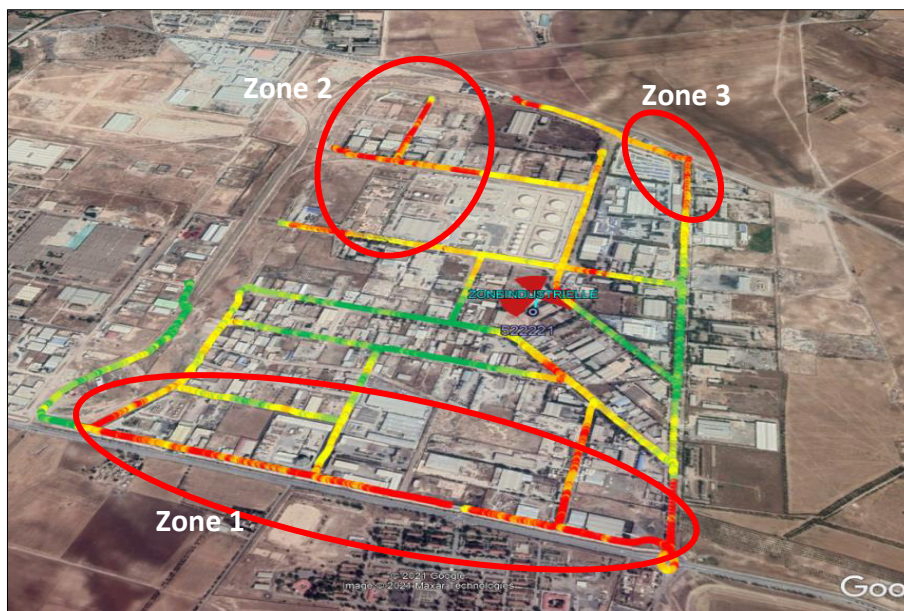
Figure IV.23 : Les zones dégradées de site ZI.
