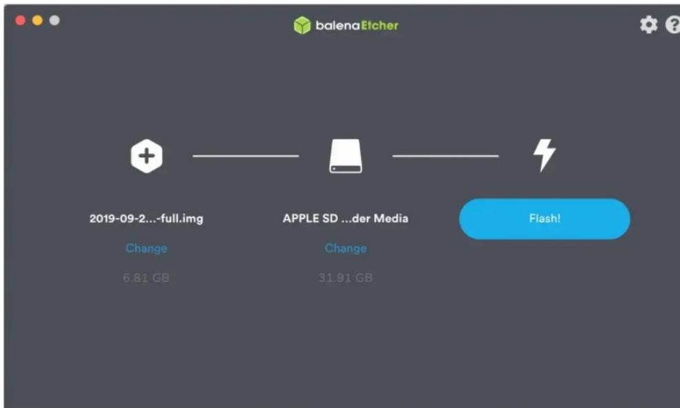
**Figure 3.3.** "flash" : graver notre OS dans l'objet sélectionné
