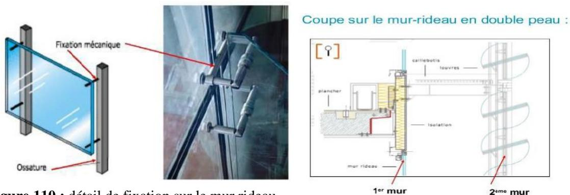
Figure 110 : détail de fixation sur le mur rideau
