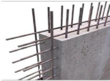
**Figure 93 :** Voile en béton armé
