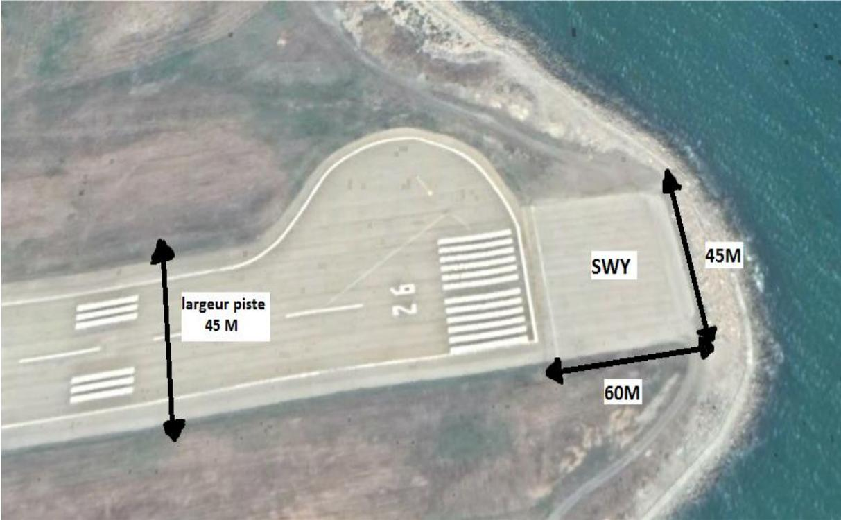
Figure 3.5 : Dimensions du SWY et largeur de la piste de Béjaia [26].
