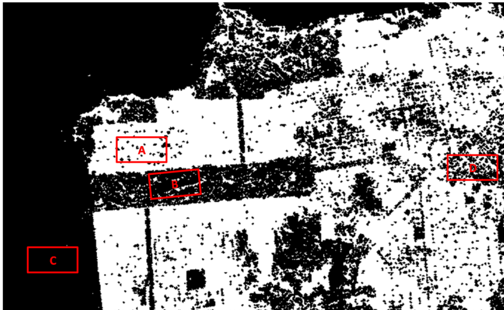
Figure 3.6 : Résultat de la détection des zones urbaines après l'opération de la fermeture morphologique
